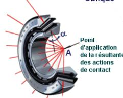
L'intensité de la charge est le facteur qui détermine habituellement la taille du roulement, il conditionne aussi le type de roulement à utiliser, en suivant les remarques précédentes, nous voyons que les roulements à rouleaux sont plus à même de transmettre des charges importantes.
